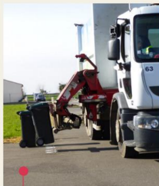
Le bras articulé est actionné par le chauffeur pour prendre le bac.
